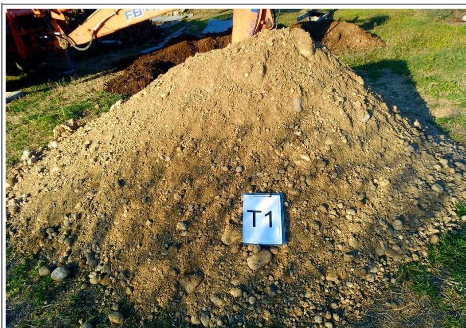
Fig. 8. Particolare dei depositi fluvioglaciali ghiaiosi e ciottolosi in matrice sabbiosa e limosa in giacitura naturale che caratterizzano il primo sottosuolo dell'area di studio.
