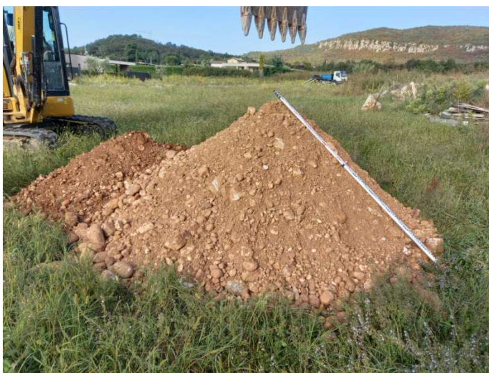
Cumulo dei depositi ghiaioso sabbiosi rinvenuti durante l'esecuzione dello scavo esplorativo n.2
