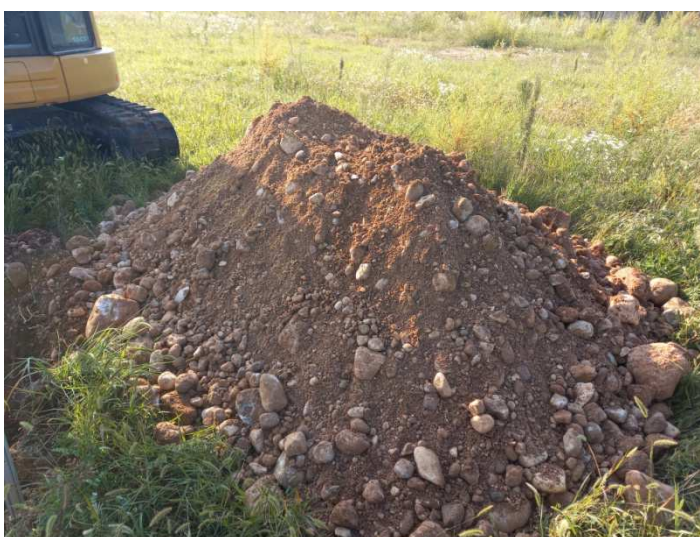
Cumulo dei depositi ghiaioso sabbiosi rinvenuti durante l'esecuzione dello scavo esplorativo n.3
