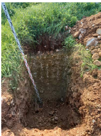
Vista d'insieme della stratigrafia relativa allo scavo esplorativo n. 1
