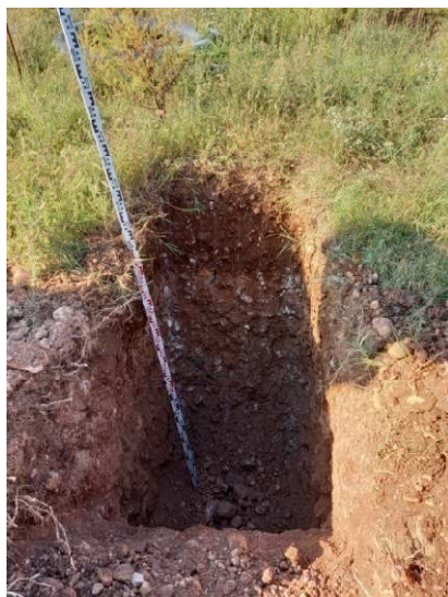
Vista d'insieme della stratigrafia relativa allo scavo esplorativo n.4
