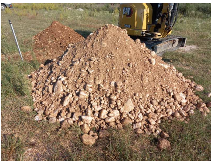
Cumulo dei depositi ghiaioso sabbiosi rinvenuti durante l'esecuzione dello scavo esplorativo n.4
